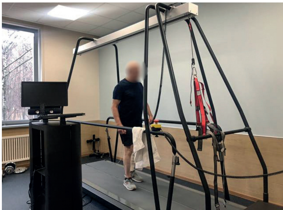
Многофункциональная система с БОС для биомеханической коррекции навыков ходьбы «T-Mill».
